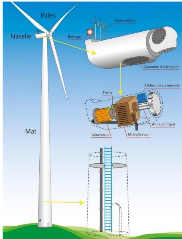
**Figure 145 : Fonctionnement d'une éolienne**
